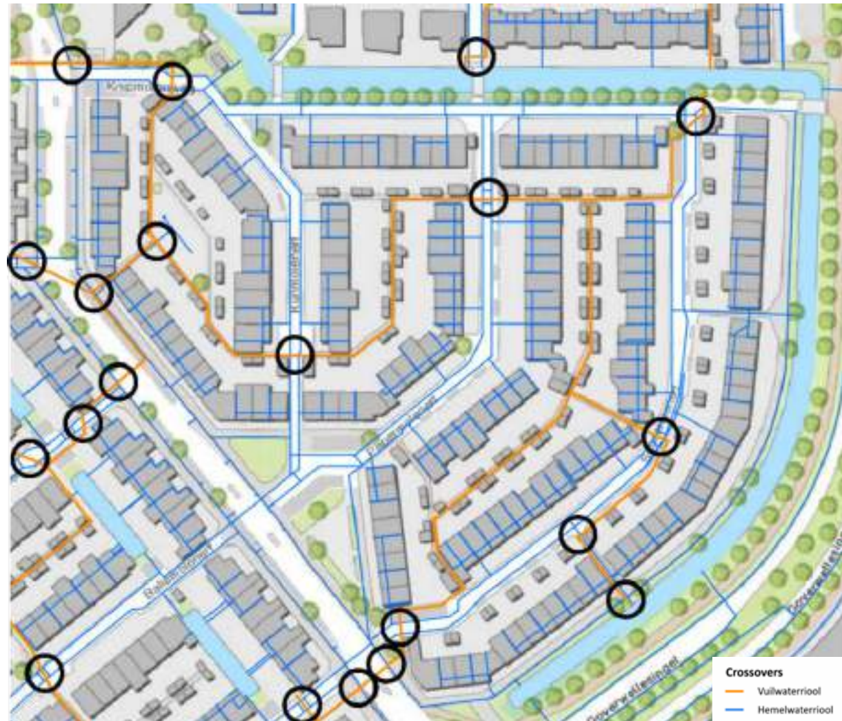
Op verschillende locaties kruist het onderheide vuilwaterriool de buizen voor de hemelwaterafvoer. Hemelwaterbuizen kunnen hierdoor makkelijk breken. Hier een uitsnede uit de Molenbuurt.
